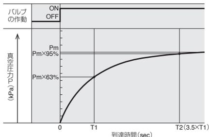
Pm: 最終真空圧力 T1: 最終真空圧力 Pm の 63% に到達する時間
