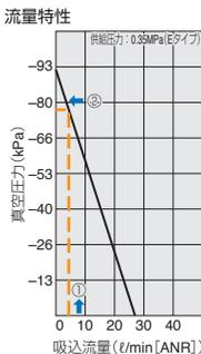
※VSE12 のカタログ表記における真空圧力は、-90 ~ -92kPa となっておりますが、ワークと真空パッド開口部の有効断面積により、実際の真空圧力は、-77kPa まで降下することが分かりますので、ワークと真空パッド開口部の有効断面積を考慮して真空機器の選定を行ってください。
