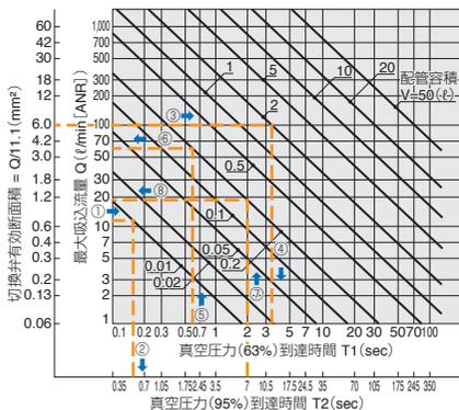
※吸着応答時間より、逆に真空発生器のサイズや真空ポンプ対応システムの供給弁のサイズも求めることができます。
