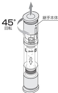
②. 回転させた継手本体をフィルタカバーから外し、フィルタエレメントの交換を行います。交換の際には、フィルタエレメント吻合部にフィルタエレメントを半分挿入して、フィルタエレメント端面を潰さない様に継手本体Aに挿入してください
